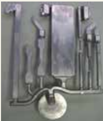
NADIA reference die for die casting (CEN/TR 16748)
