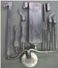
NADIA reference die for die casting (CEN/TR 16748)
