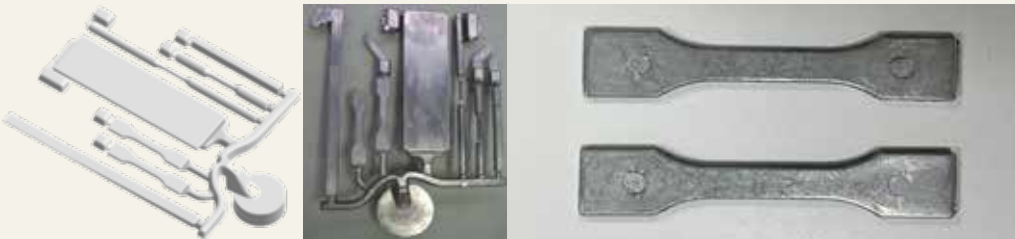
NADIA reference die for die casting (CEN/TR 16748)
